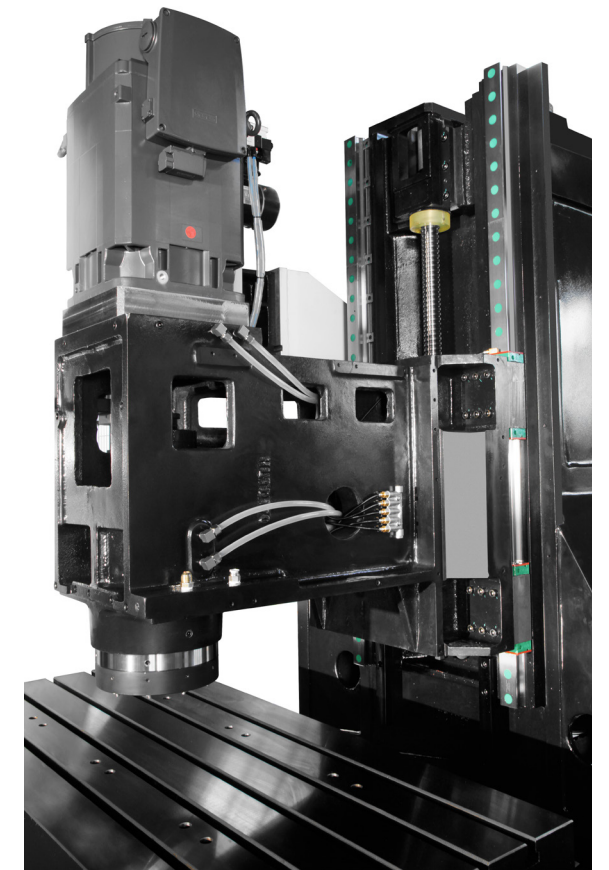
Gusseisen, das zum Spannungsabbau gehärtet wurde, um strukturelle Stabilität ohne Verformung zu gewährleisten
