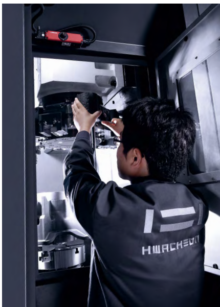
Die Bestückung des Revolvers erfolgt bequem von der Seite durch eine zweite Maschinentür (VT-650).
